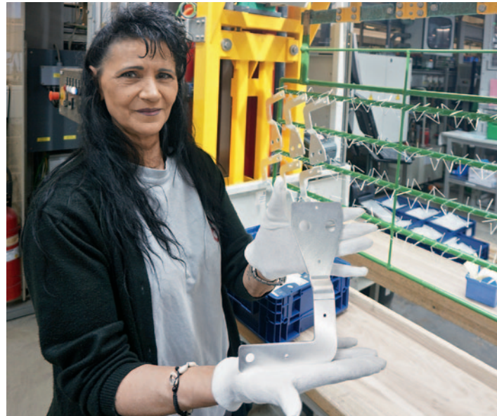
Addolorata De Leonardis mit einem sogenannten Busbar, der im Auto Strom von der Batterie zum Generator leitet
