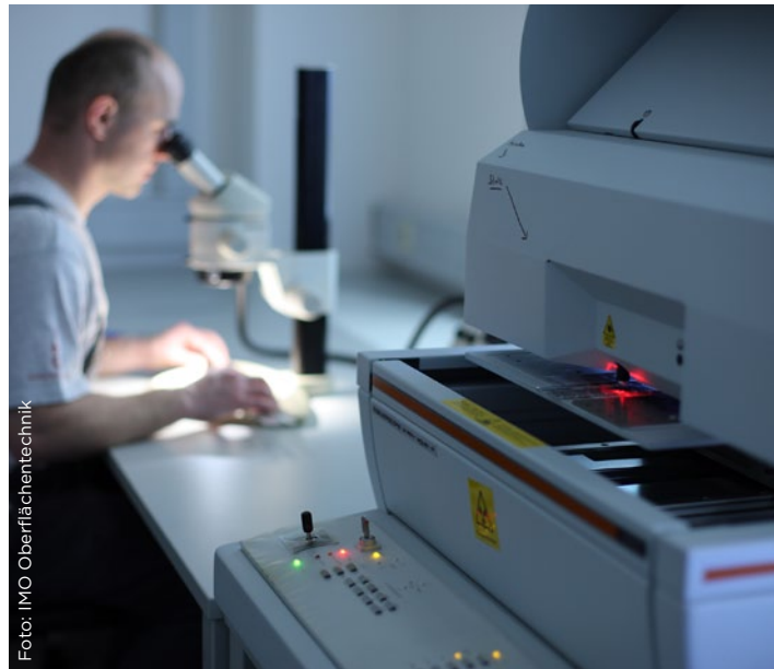
Qualitätsprüfung im laufenden Prozess. Das Messgerät gleicht Bauteile mit gespeicherten Messwerten ab
