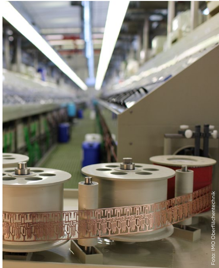
Rollenführung des Metallbands an einer der Bandanlagen
